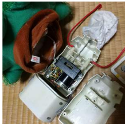
2) ホットボンドを除去し、4本のビス外して底面の電池ボックスネジも外して分解
