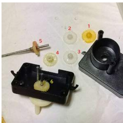
3) ギヤボックス内のグリスが固着していたバラバラに分解して洗浄後、グリスアップ
