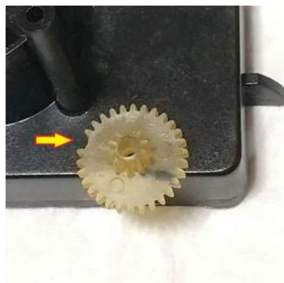
4) モーター直近の大事なギヤが、歯欠け！透明素材で、接着剤が効かない代物
