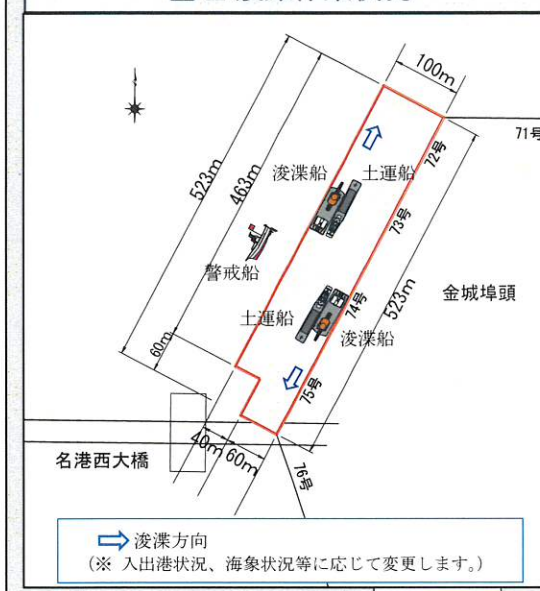
図2 浚渫作業状況
