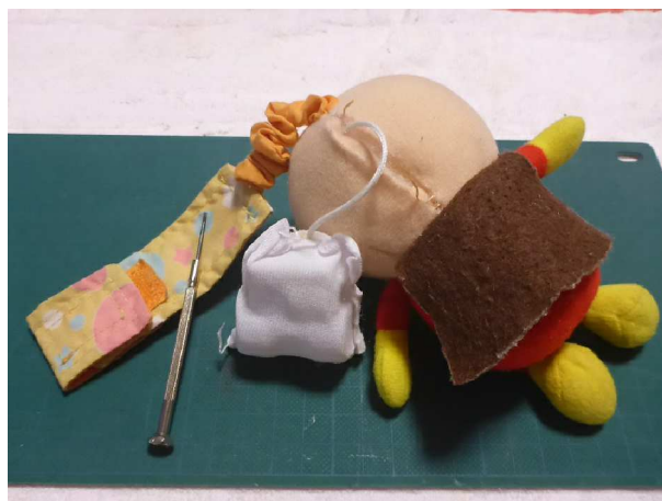
本来は、ヒモを引っ張るとゼンマイが巻き戻って、鈴を鳴らしてブルブルと震えるはず。ヒモが伸び切って、戻らない状態。
