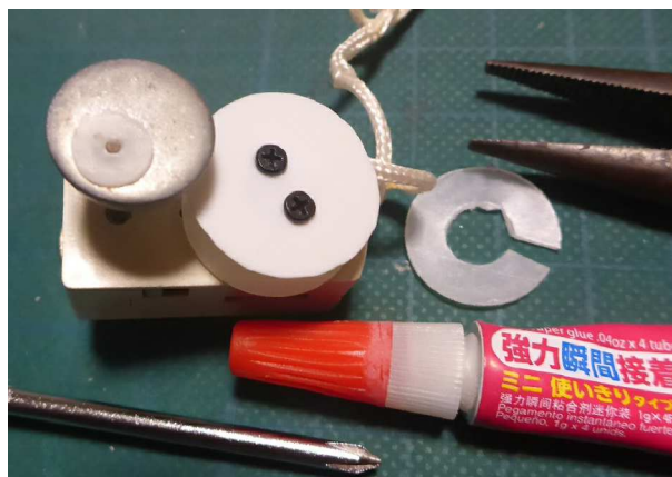
ドラム完成。伸び切っていたヒモをドラムに巻いてから、組み立て直し。巻き上げができるようになり、ブルブル動作確認。
