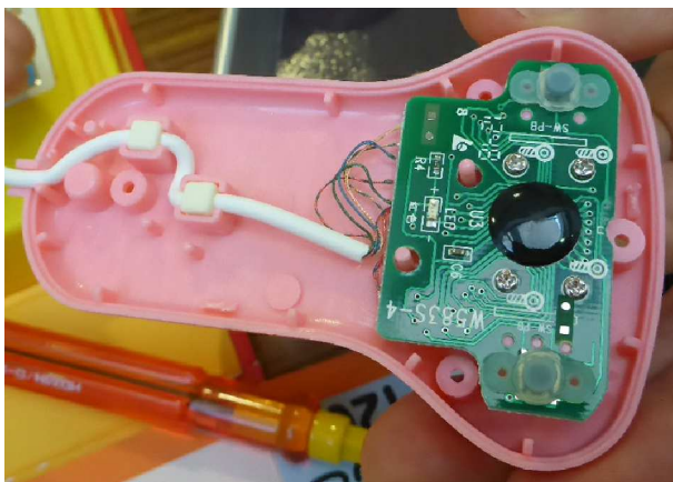
念のためスキヤナを分解点検。リード配線や基板パターン切れ等の異常がないことを確認。当病院では修理不能と判断し、お客様にメーカーサポートへの連絡方法を説明しました。
