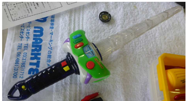
ディズニーの光る剣。貰いものだが最初から音が出なかったらしい。スピーカー自体の不良が原因。こんなこともあるのかと、ドクターも驚き。その訳は…
