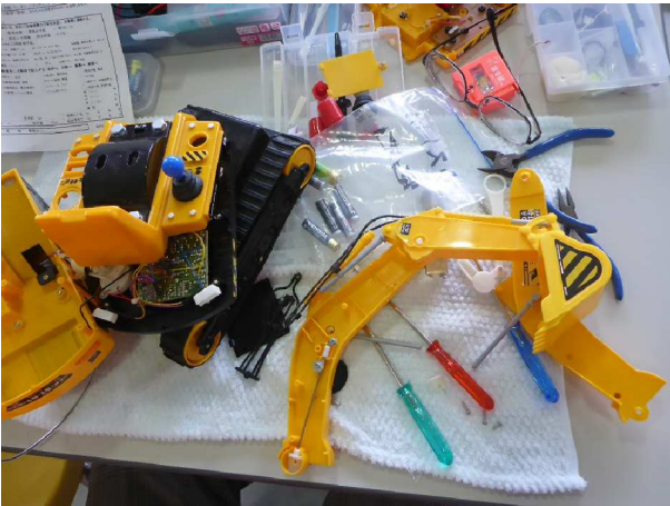
ラジコンショベル。あちこちでプラスチックが割れている。男の子用おもちゃの故障に多い症状。接着補強に時間を要す。入院決定。
