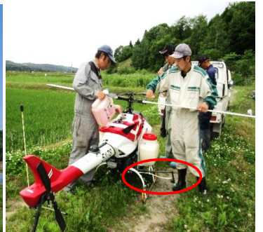
1haあたり約6分で薬剤をまくことができ、壮大な田んぼでは欠かせない存在です! 薬剤は下の黒い管からシャワー状に噴射されます!!
