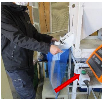
2/17 温湯消毒の小分け作業がはじまりました(*´-`*) ボタンを押すとしっかり5kgの種子が溢れ出てきます！
