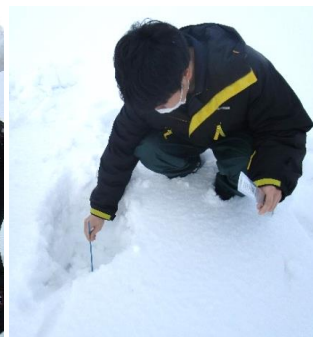
掘った穴に棒を刺し、先端に土が付いたら深さを計測します！ さて今年の積雪は？
