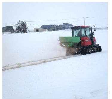
融雪剤の粒が太陽光で熱され、雪が溶ける仕組み！ 融雪剤をまいておくと7～10日程早く雪が溶けます！
