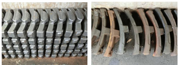
金属製のブレーキパッド(左:新品、右:使用后)
