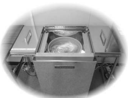
▲きざまずに測定できる非破壊式放射能測定装置
