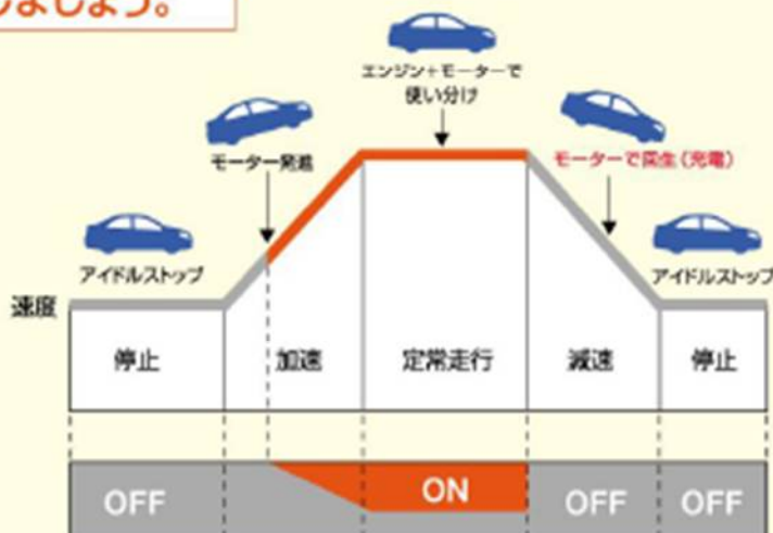
ハイブリッド車のエンジンの稼働図 (できるだけエンジンがかからない運転をしましょう)
