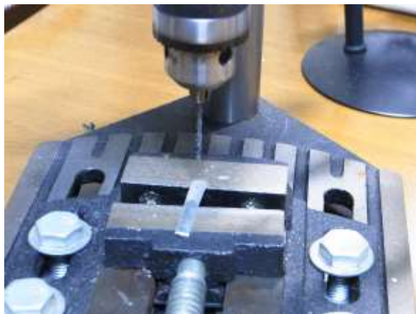
③ アルミニウムの板をボール盤で加工して副え木とすることにしました。
