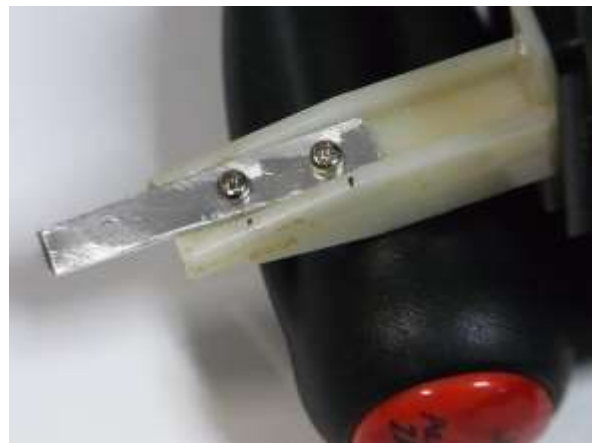
④ アルミ板と人形の右足にネジを通して固定します。
