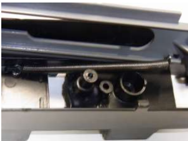
⑤バネを引っ掛けてから可動ギヤを取り付 け、上下のギヤ（画像省略）の位置合わせ をして完了。
