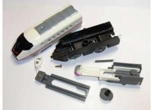
②全体を分解して点検。可動ギヤが本体から 外れています。
