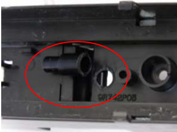
③可動ギヤを固定するシャフトが根本から 折れています。
