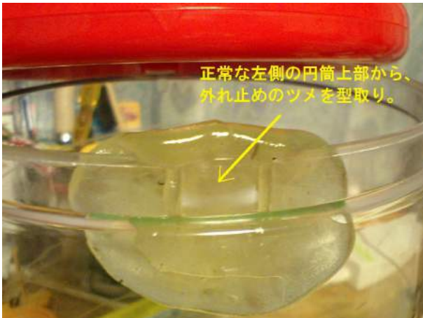
正常な左側の円筒上部から、 外れ止めのツメを型取り。 正常な左側の円筒上部から型取りして、破損した反対側のツメを復元再生してみよう。 造形補修用接着剤の評価は、色々だが。
