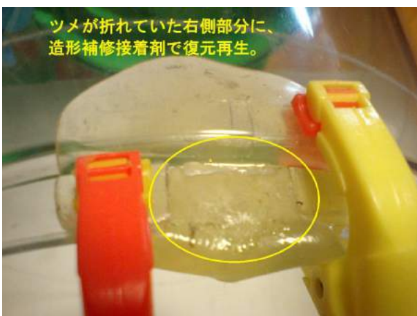
ツメが折れていた右側部分に、 造形補修接着剤で復元再生。 ツメが折れていた右側部分に、造形補修接着剤で復元再生。今回は「プラリペア」を使用。一応、実用強度は確保できた。
