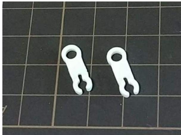
アドバンス連結器の変形を、加熱して復元修正
