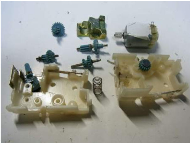
ギヤボックス分解、ギヤ取り出し清掃 スイッチ調整、モーターも分解整備
