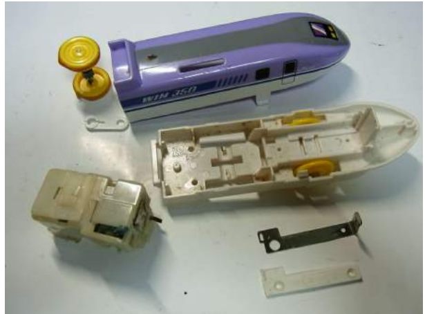
電極接点を研磨清掃、タイヤゴム交換 連結器交換、ギヤボックス動作確認
