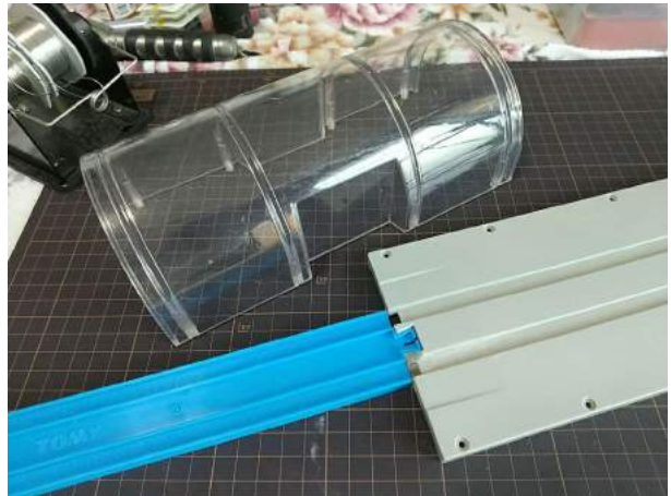
トンネル接合凹部の破損、型取りし造形補修 青いレール凸部との接合を可能とする
