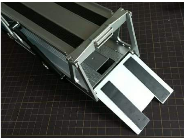
薄いゴム板を細長く切り、傾斜路の滑り止め 外観やあそび方は、ネット動画から学習した
