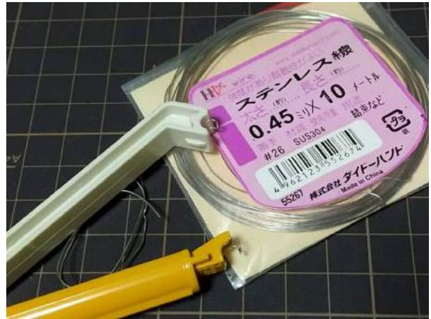
割れた爪は、接着剤だけでは強度不足は明らか ステンレス線で芯を入れ、補強してみる
