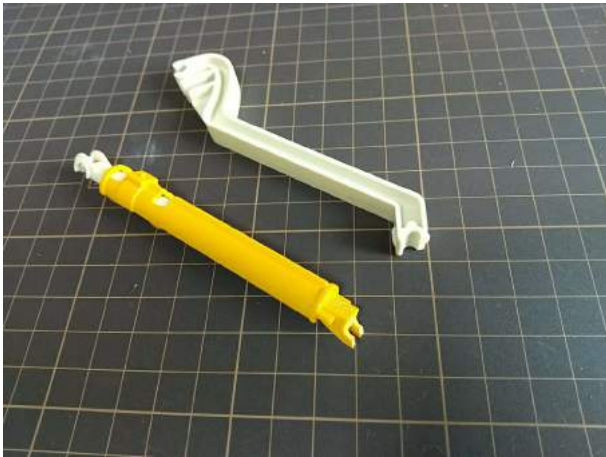
バケットリンク(白)は、手前側の爪折れ アームシリンダー(黄)も手前側の爪折れ
