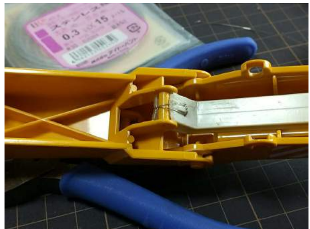
まだ外れやすいので、ステンレス線で縛り付け 幸い、この個所はアームの肘に隠れて見えない
