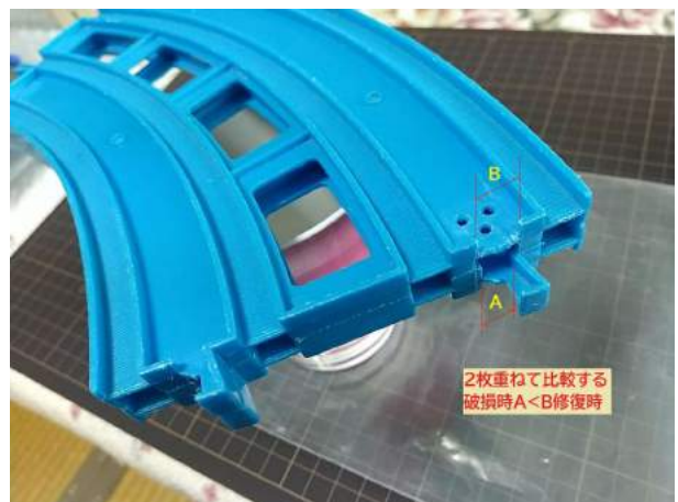
プライマー塗布後、2枚重ねて比較 元の厚みの分 AよりBを 広く取った
