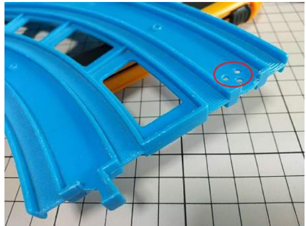
ヒビ割れた凸部は取り去り、少し間口を広げ 引っ張りに備え、ミニドリルで小穴を空ける
