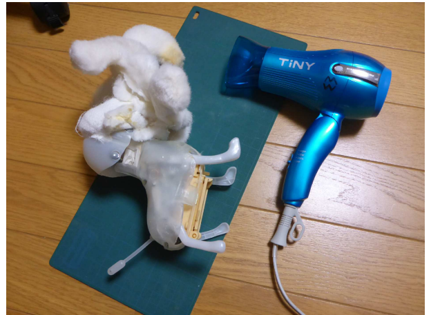
モーター音するが、動かない。おなかの電池BOX部分から頭部以外の外被覆を脱がして点検。しっぽや手足は折れていない。スイッチや電源回りも異常なし。
