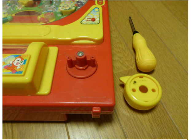
「打ち出したパチンコ玉が途中までしか上がらない」原因は、パチンコ台裏面のストッパーが掛かっていたため故障ではなかった。球の打ち出し部も異常ありません。
