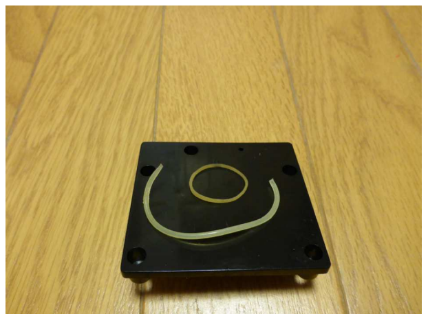
このような普通の輪ゴムでは柔らかすぎて、動力を伝達する前にゴムだけが伸びてしまうようである。少し大きめの輪ゴムを二重にして、かろうじて動くようになった。
