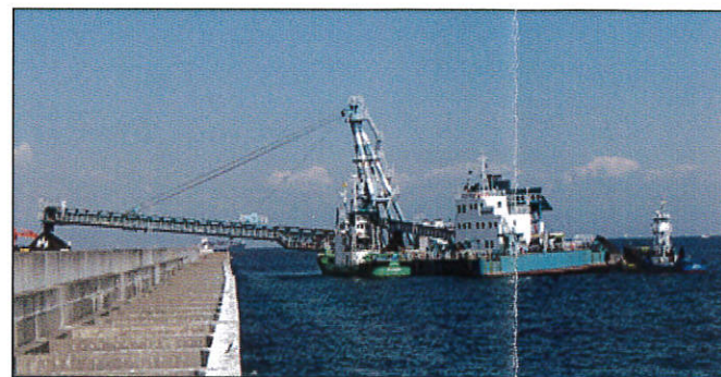
バックホウ式揚土船『オーシャン2号』 船体寸法：73m x 26m x 4.3m
