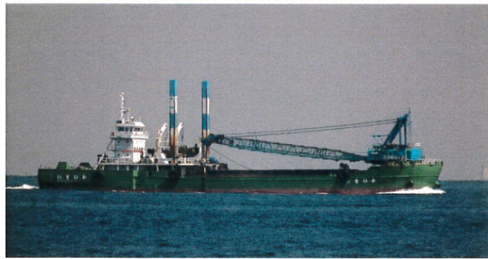
多目的起重機船：かいせい(L=76.1m)
