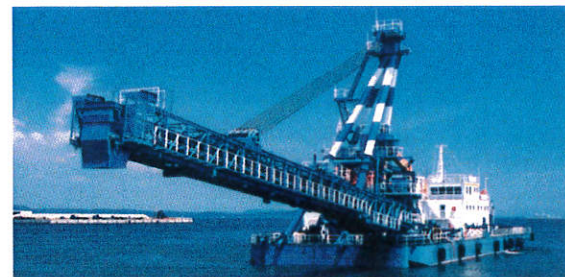
◎バックホウ式揚土船「オーシャン2号」 船体寸法：7.3m×26m×4.3m
