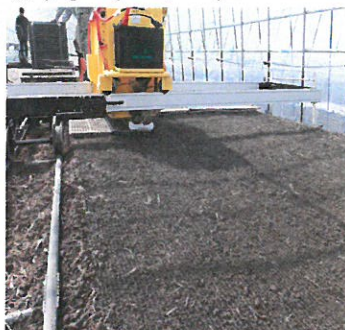
ポットを並べていきます。左右7枚ずつ機械で自動に並べていきます。v(・▽・)ノワフォーイ♪
