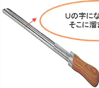
農産物検査法で定められた抽出方法で、『穀刺し』という器具を使ってお米を抽出。
