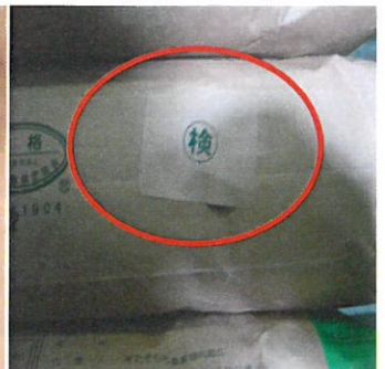
そんな穴には、『丸検シール』をペタッと貼って補修していきます。
