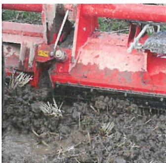
種蒔きと同時進行で田起こしをしていっています。土を碎き空気に触れさせ、稻の栄養となる窒素分を吸収しやすくする働きがあります。
