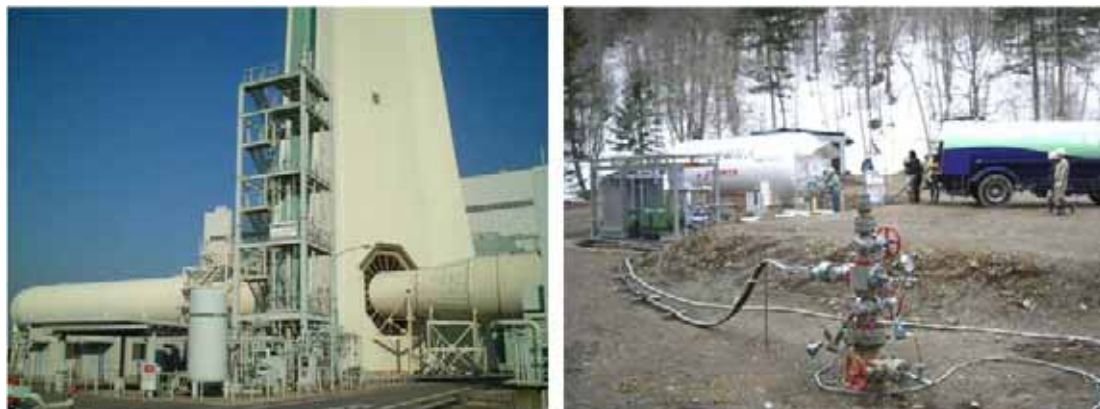
排出された CO2 を分離回収し（左）地中の炭層中に吸着固定させる（右）
